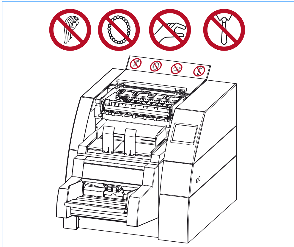
Abb. 3-3 Sicherheitszeichen und Schilder am oberen Auslauf
