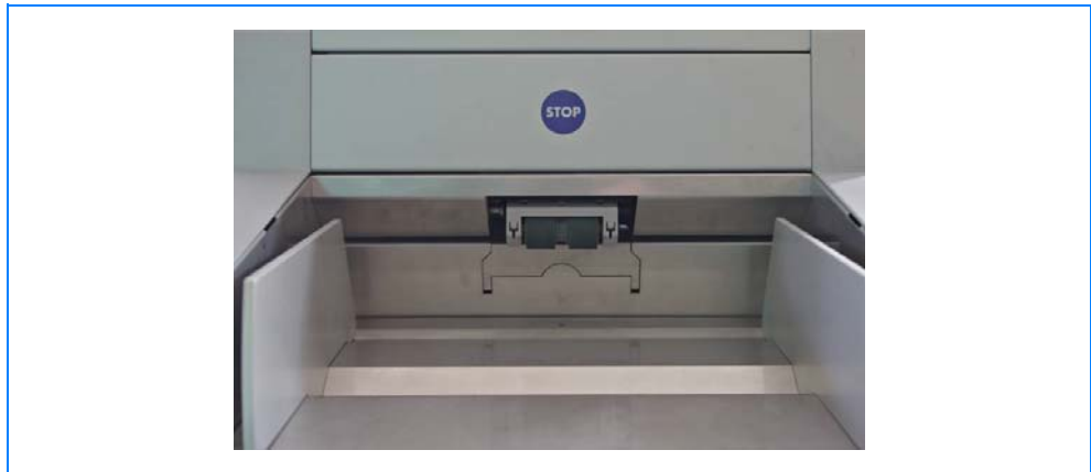
Abb. 8-2 Feedertisch in 500 Blatt Position
