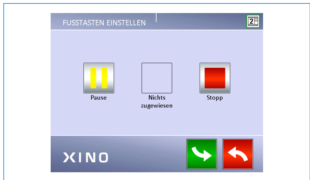
Abb. 6-26 Fußtasten einstellen (Beispiel mit 3 Tasten)
